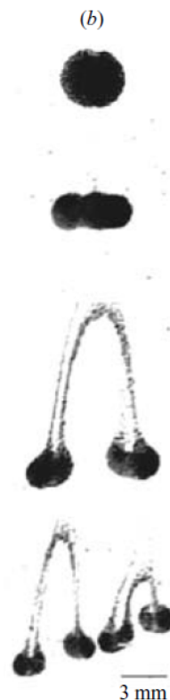
Rysunek 1: Rozpad kropli zawiesiny kulek silikonowych o średnicy 60\text{ }\mu\text{m} w wodzie. Źródło: B. Metzger, M. Nicholas, E. Guazzelli, J. Fluid Mech. 580 , 283 (2007).
